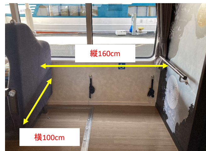
車いすスペース
